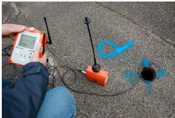
Exemple d'équipement d'un point avec pose d'un des deux capteurs
