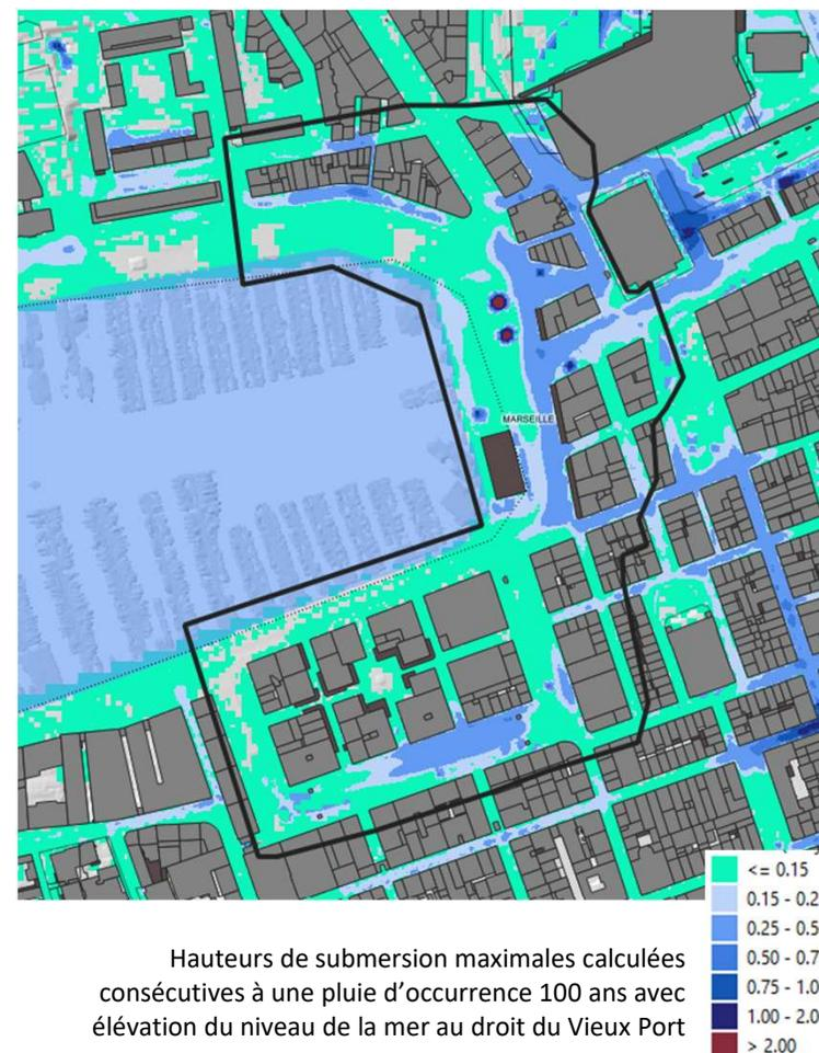
Hauteurs de submersion maximales calculées consécutives à une pluie d'occurrence 100 ans avec élévation du niveau de la mer au droit du Vieux Port
