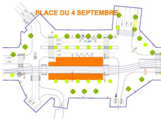
Figure 19 : Place du Quatre Septembre - variante d'insertion latérale
