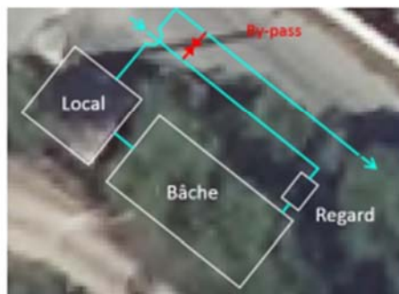
FIGURE 13 : AMENAGEMENT D'UN BY-PASS DU SURPRESSEUR
