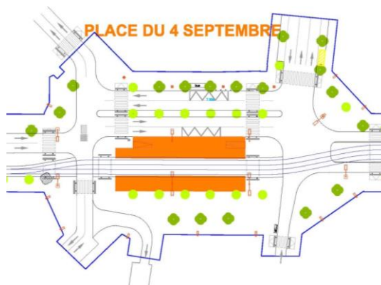
Figure 19 : Place du Quatre Septembre - variante d'insertion latérale
