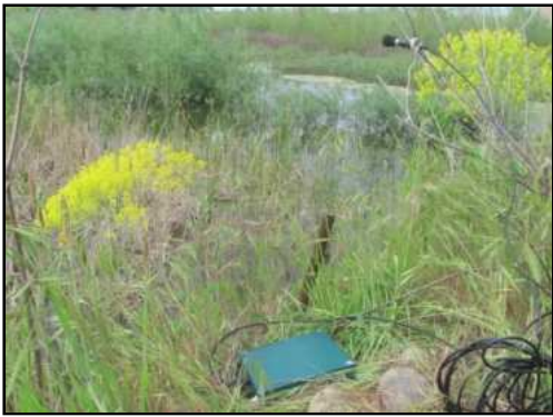
Enregistreur continu de type SM2BAT ECO-MED
