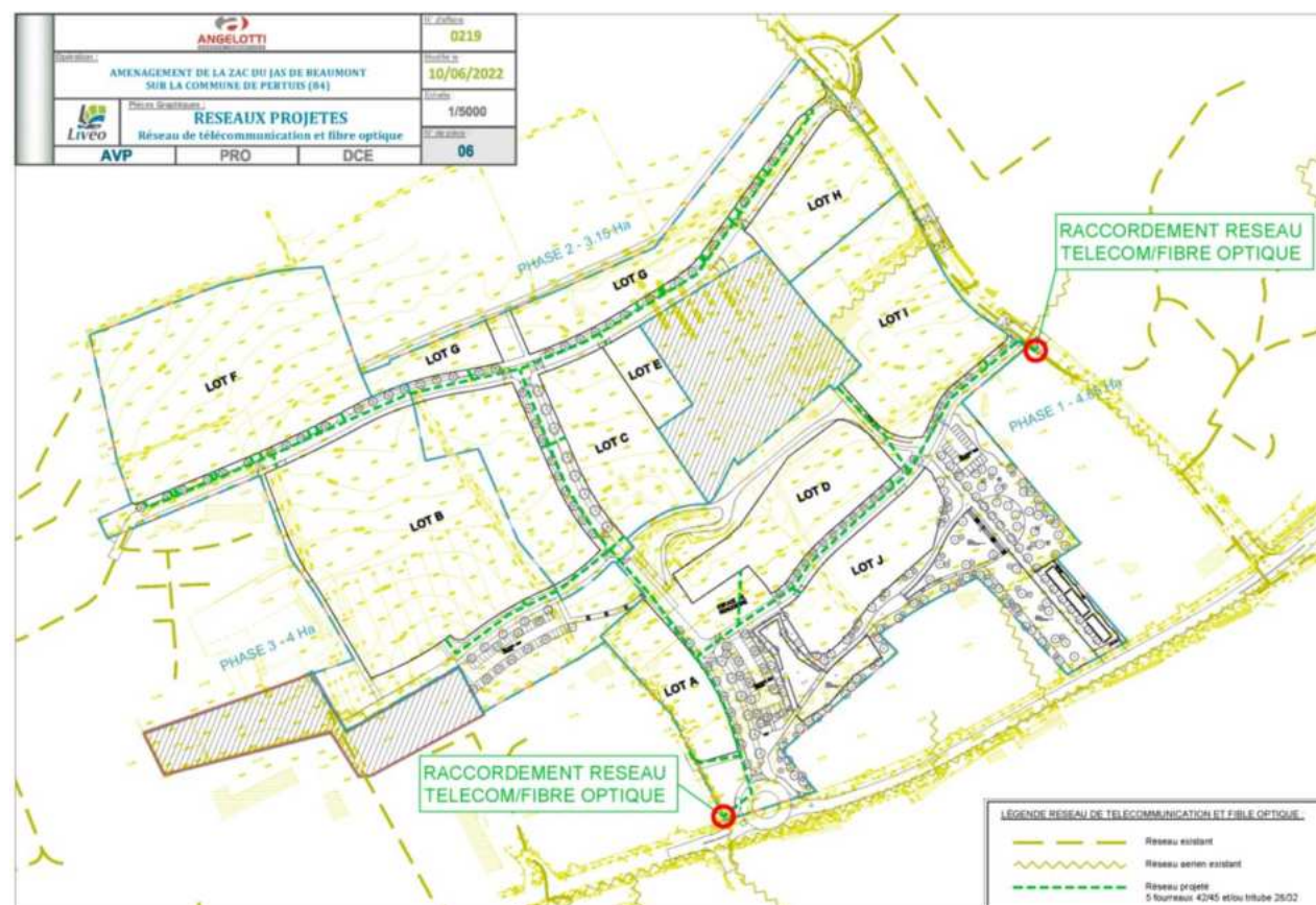
Réseau de télécommunications et de fibre optique
