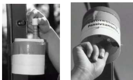
Figure 1 : Illustration de l'installation des tubes passifs de \text{NO}_2
