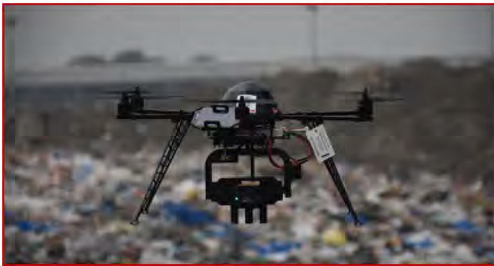
Drône utilisé : Hexacoptère de 1.2m d'envergure
