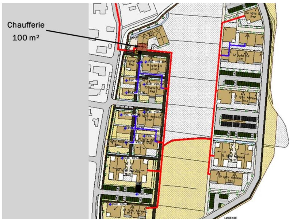
Le réseau sera connecté dans les deux chaufferies et il y aura un organe de pilotage pour l'ensemble de la production permettant le relais ou le secours d'un site avec l'autre.
