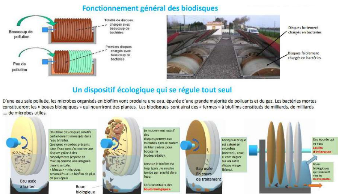
Figure 52 : Synoptique de traitement de la nouvelle STEP du pigeonier basée sur des bioprocédés : Focus sur les biodisques .
