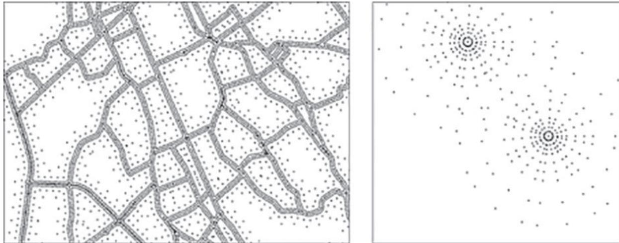
Figure 18: Exemple de positionnement des points de calculs pour le traitement des sources linéaires (gauche) et des sources ponctuelles (droite)
