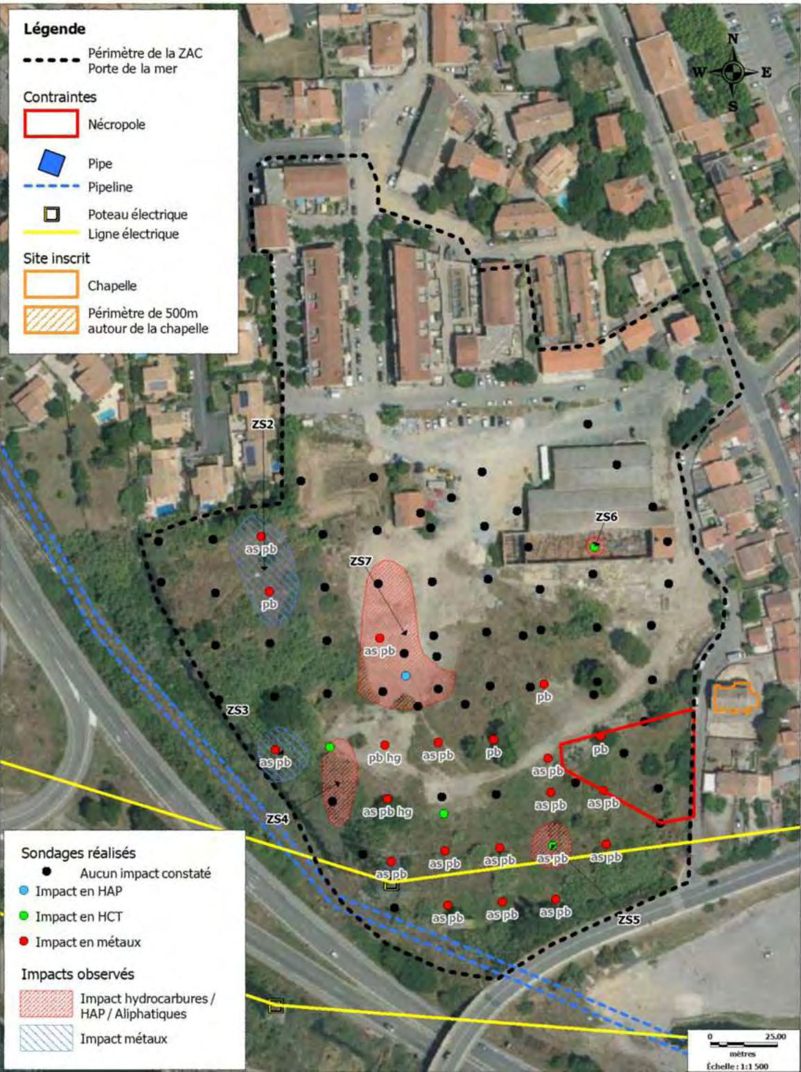
Figure 60 : Localisation des sondages et des zones polluées sur la zone d'étude (source : BURGEAP)
