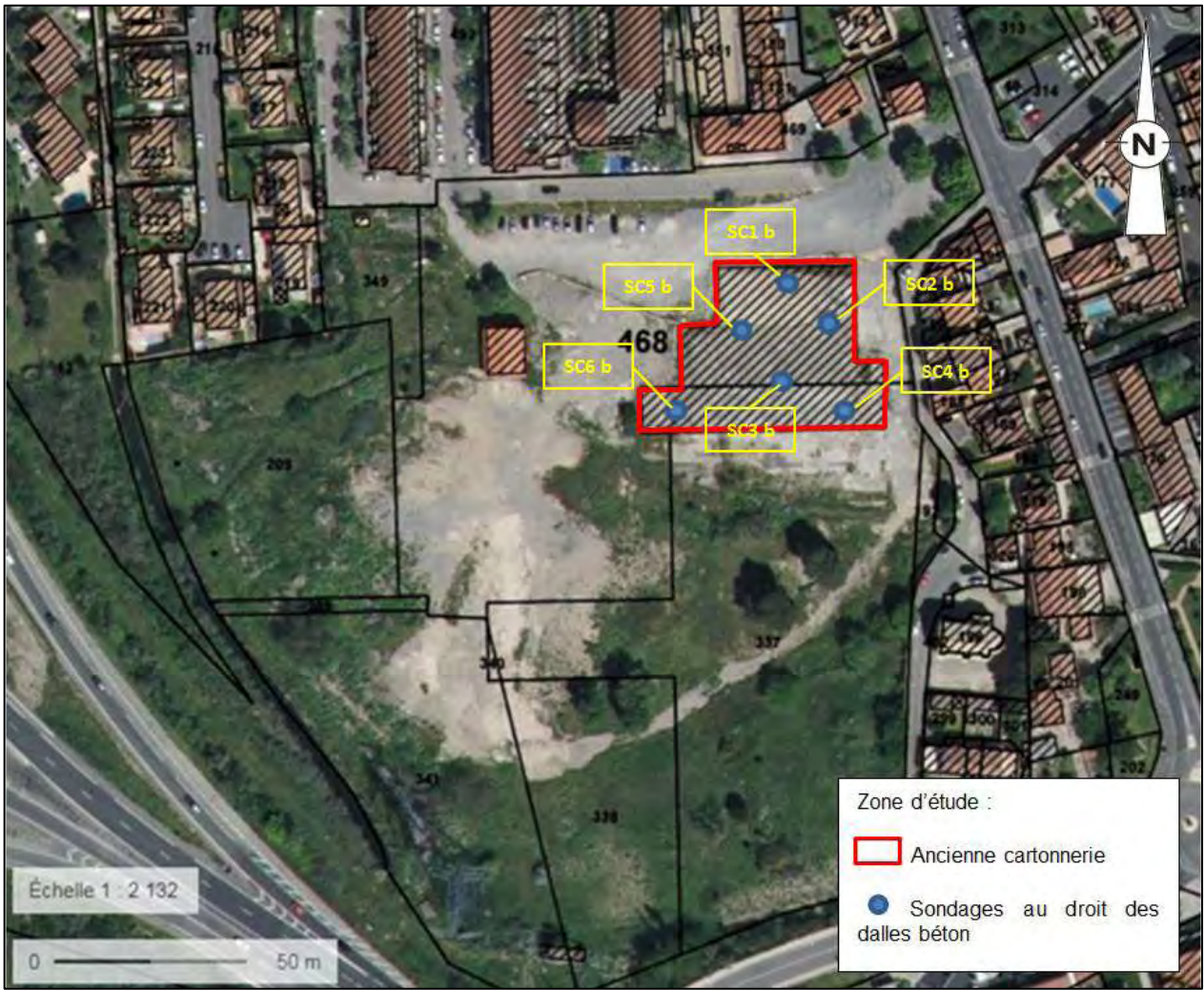
Figure 61 : Localisation des sondages au droit des dalles béton de l'ancienne cartonnerie (source : BURGEAP)
