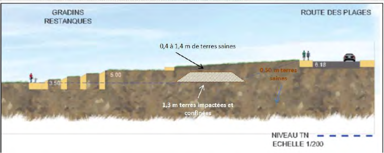
Figure 63 : Schéma de la coupe type du confinement sur site proposé pour les terres impactées (source : BURGEAP)
