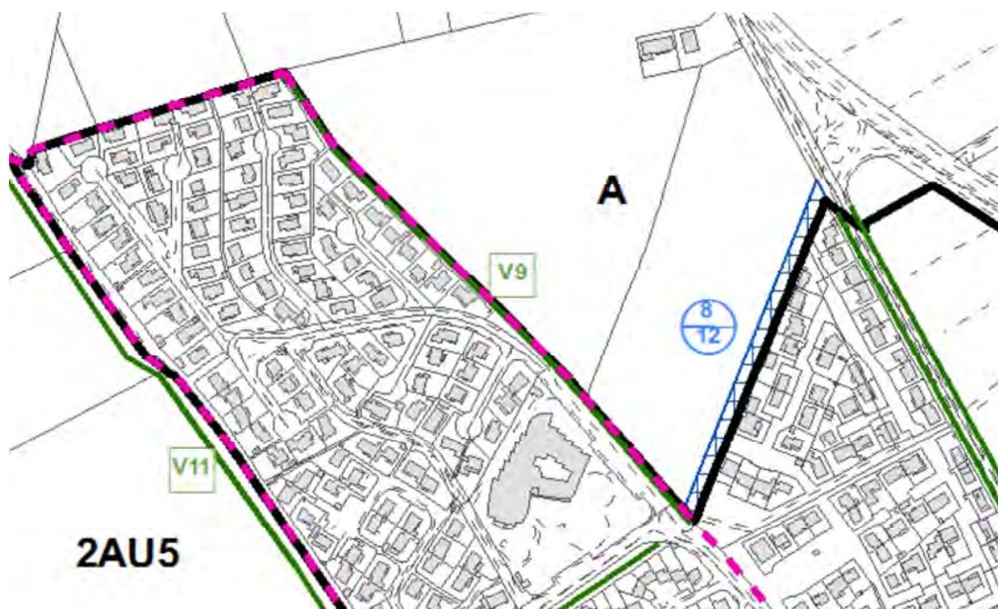
Matérialisation de la bretelle d'accès à la ZAC, en emplacement réservé n°8 au PLU (en quadrillé bleu ci-dessus).
