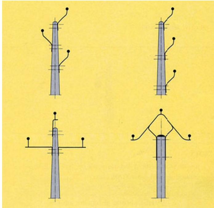
Figure 3 : Réseau électrique HTA - Technique rigide
