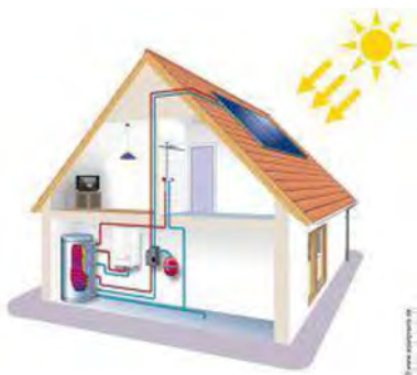
Figure 65: schéma de principe de fonctionnement des capteurs solaires thermiques
