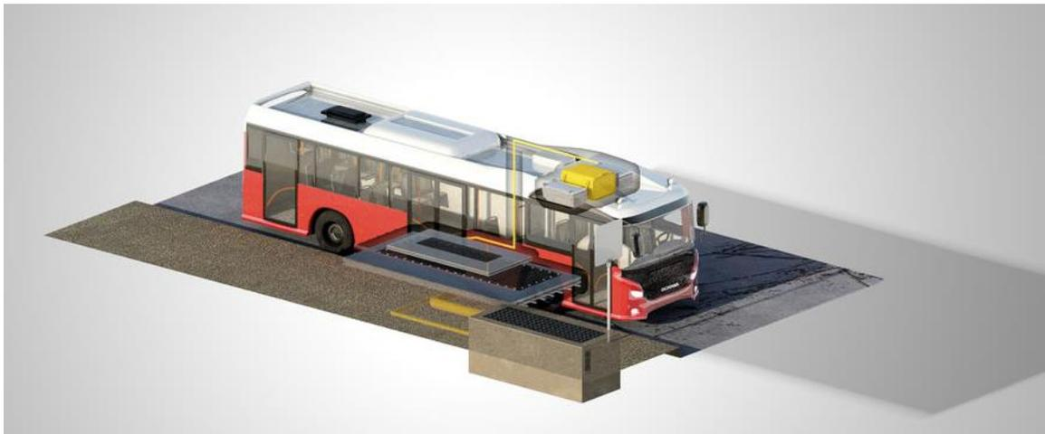
Illustration d'un système de rechargement par induction avec véhicule Scania
