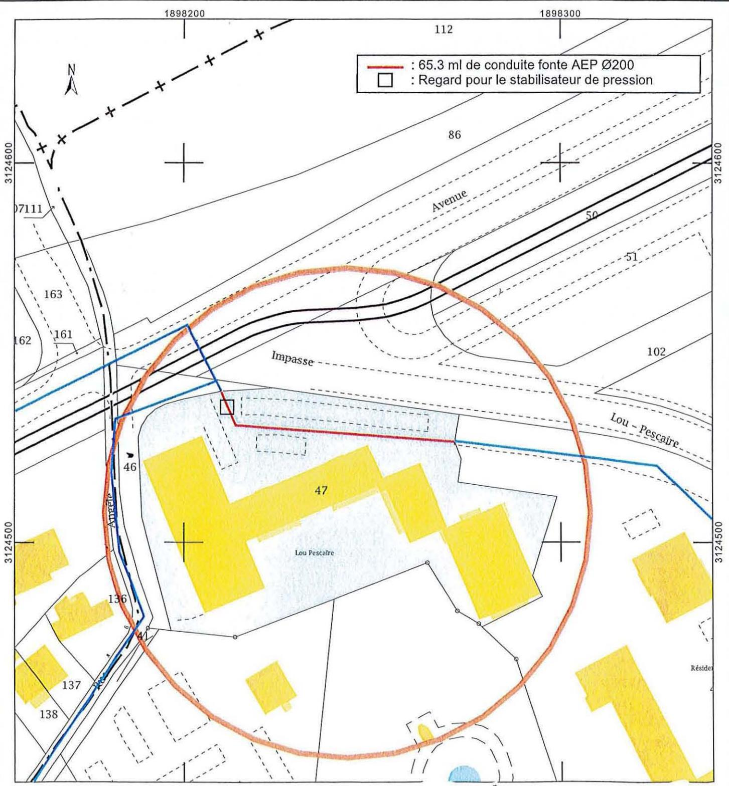
— : 65.3 ml de conduite fonte AEP Ø200
