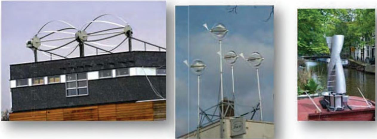
Figure 7 : Exemples d'éoliennes urbaines (de type Darrieus, Venturii et Savonius)
