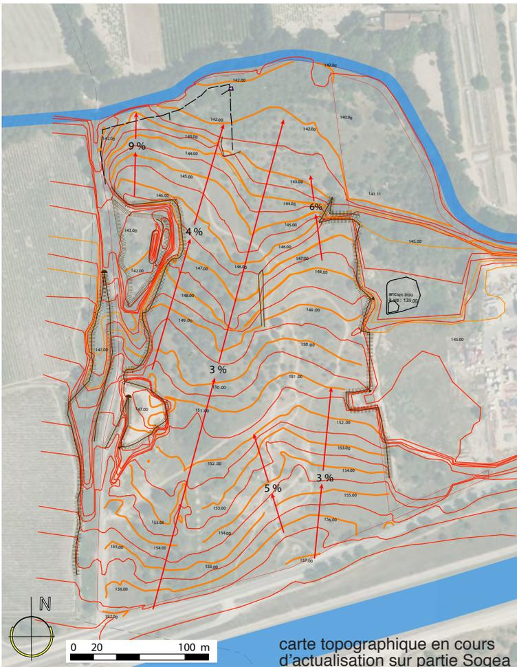
L'altitude la plus élevée est de 156 m NGF en limite sud au niveau de la RD 561 et la plus basse est de 142 m NGF en limite nord, le canal de Craponne se situant sensiblement 3 mètres plus bas. Les dimensions du site sont d'environ 400 m du nord au sud et 300 m d'est en ouest.
