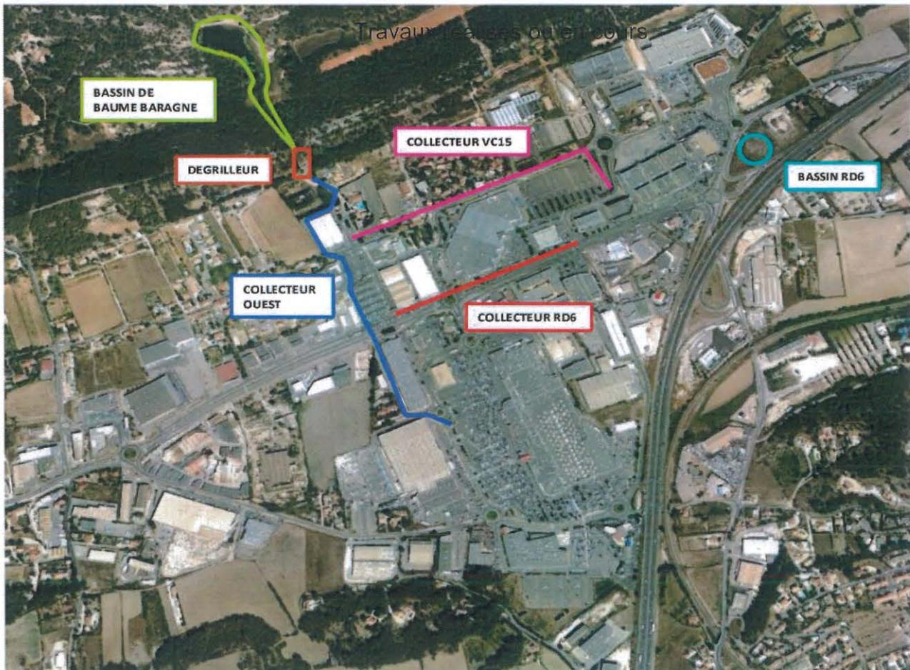
Le présent Avenant a pour objet la création d'un collecteur d'eaux pluviales (VC 15) de diamètre 1.000 mm, derrière le Centre Commercial Avant-Cap.
