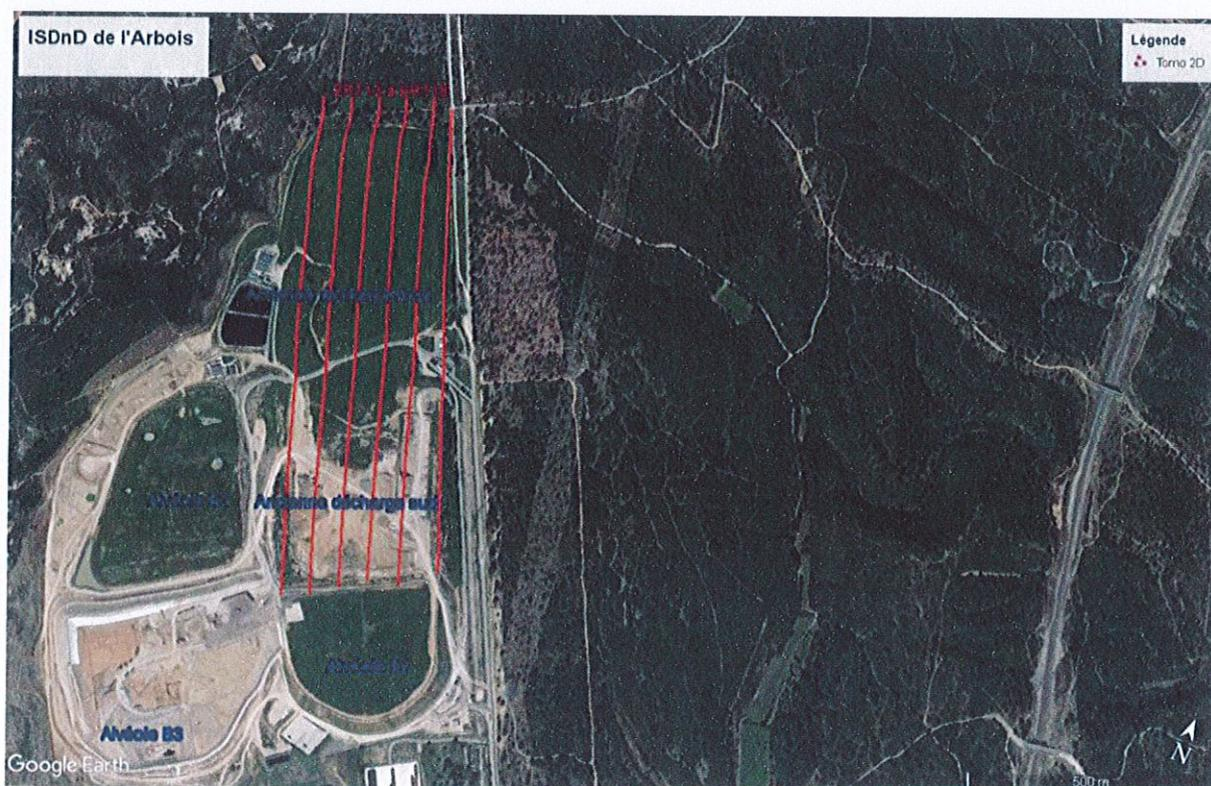
Figure 11 : Positionnement des profils de Tomographie de Résistivité Électrique 3D autour des bassins B1 et B2 de l'ISDnD de l'Arbois
