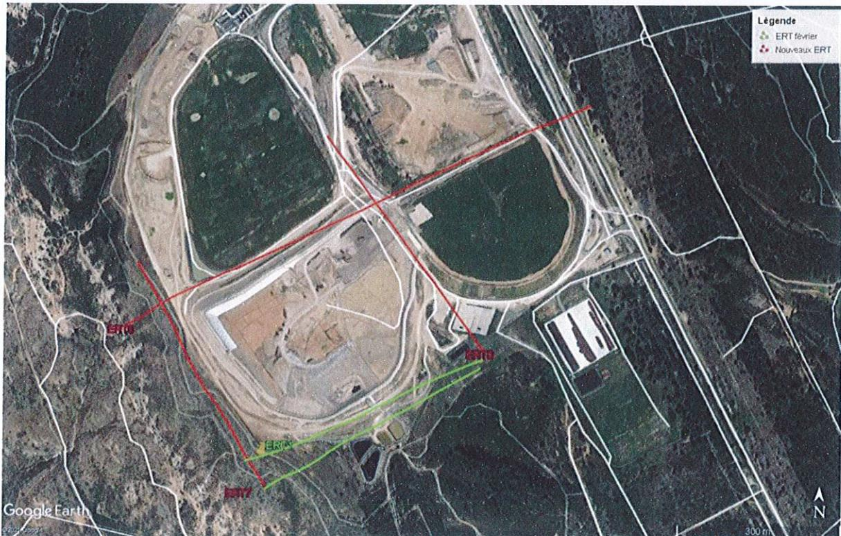
Figure 8 : Positionnement des profils de Tomographie de Résistivité Électrique 2D autour des bassins B2 et B3 de l'ISDnD de l'Arbois
