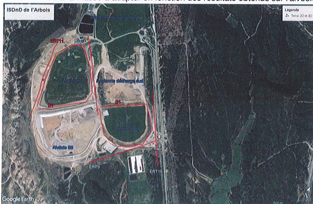
Figure 10 : Positionnement des profils de Tomographie de Résistivité Électrique 3D autour des bassins B1 et B2 de l'ISDnD de l'Arbois
