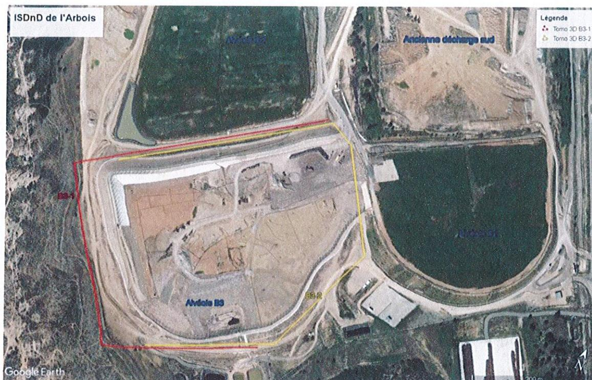
Figure 9 : Positionnement des profils de Tomographie de Résistivité Électrique 3D autour du bassin B3 de l'ISDnD de l'Arbois
