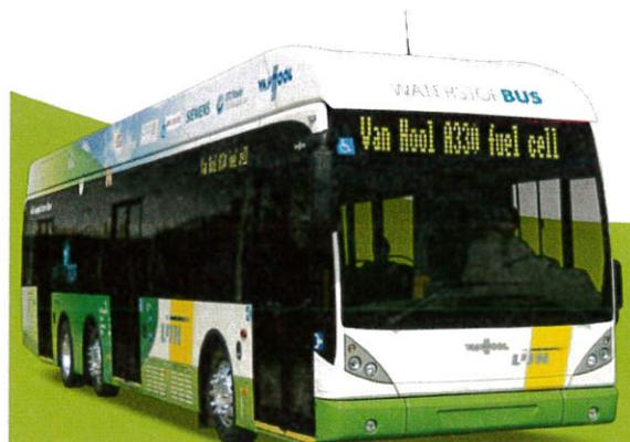
Van Hool équipé d'une pile à combustible UTC Power/Siemens
