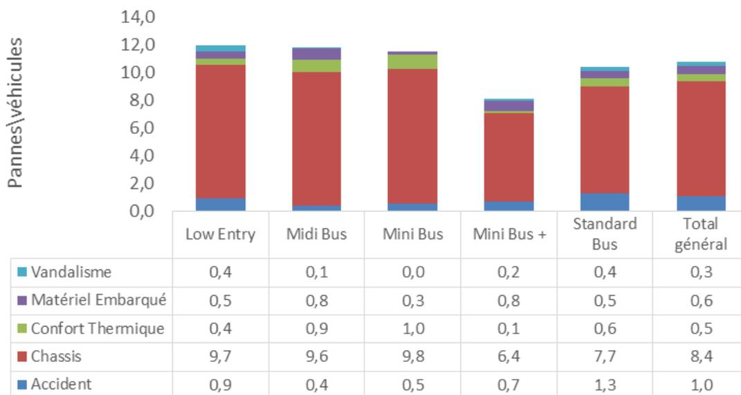
Des plans d'action sont mis en place pour fiabiliser le matériel roulant. Ainsi, les palettes PMR font l'objet d'un contrôle systématique lorsque le véhicule entre en atelier quel que soit le motif. Les niveaux de liquide de refroidissement et d'huile sont réalisés tous les jours sur une dizaine de véhicules et le solde est traité le dimanche car le taux de disponibilité, ce jour, nous le permet.
