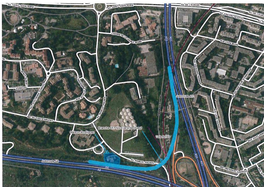
Vue de principe de la bretelle projetée entre l'A51 nord et l'A8 ouest.
