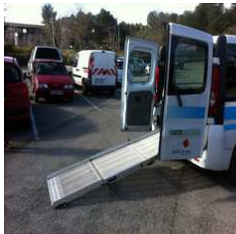
Ascenseur activé par télécommande au niveau de la porte arrière
