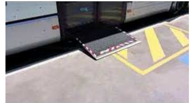
Plate-forme sur les véhicules des réseaux urbains Aix en Bus
