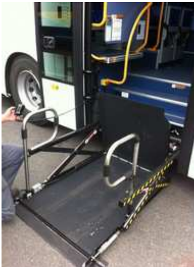
Ascenseur activé par télécommande au niveau de la porte arrière
