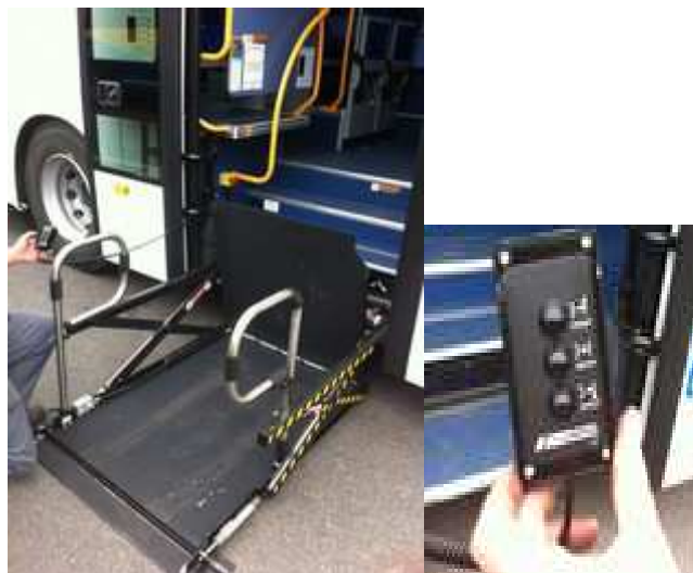
Ascenseur activé par télécommande au niveau de la porte arrière
