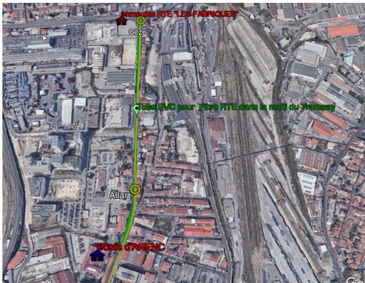
Travaux de dévoiement de la liaison souterraine à 63 KV « RABATAU-SYLVABELLE 1 » sur 1300 ml sur l'avenue Cantini, du poste RTE de RABATAU jusqu'à la rue du Rouet :
