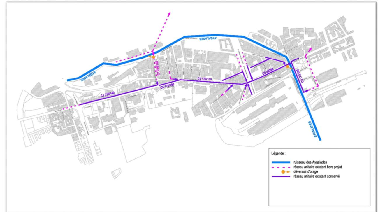
Figure 53 – Schéma général des réseaux d'assainissement existants au Nord
