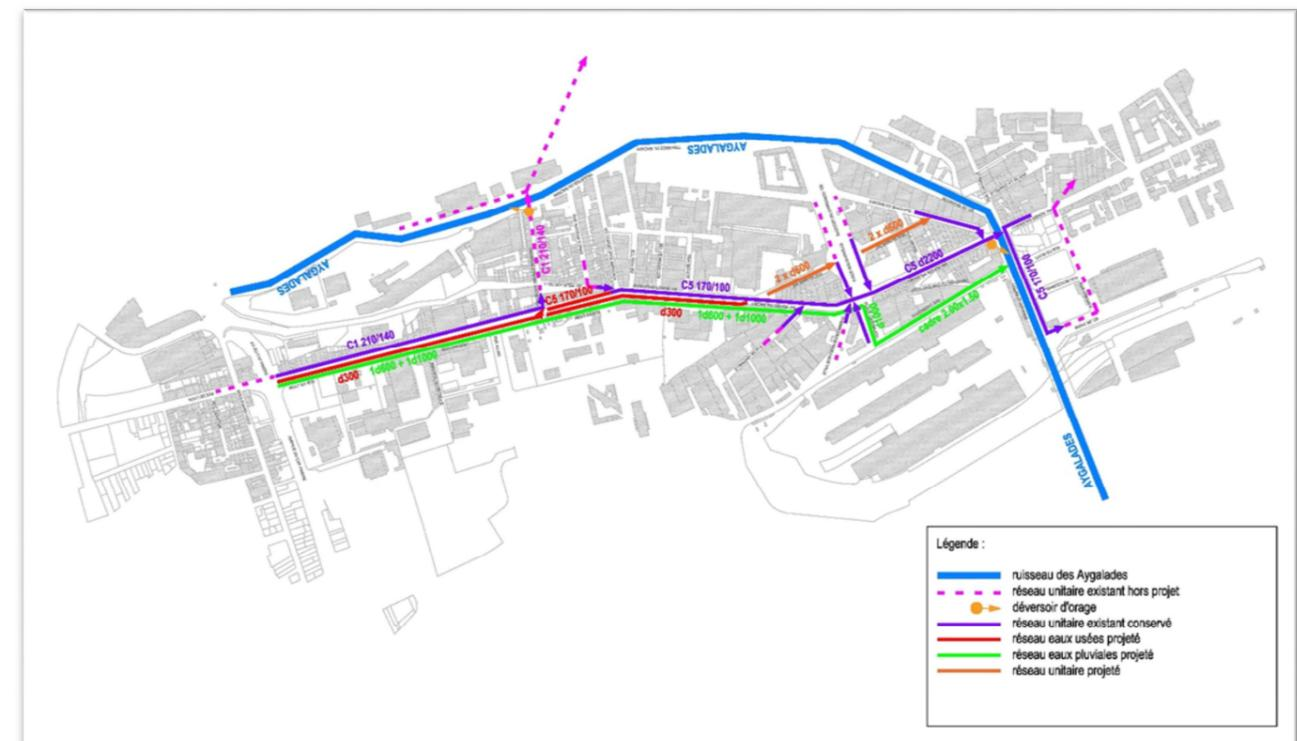
Figure 54 – Schéma général des réseaux d'assainissement projetés au Nord
