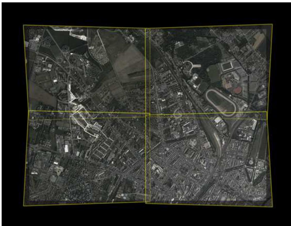
Version 60-120 mm : Vue synthétique de l'emprise respective des 4 images panchro obliques vis à vis de l'emprise de l'image basse résolution couleur. Le fait que le 120 mm soit en réalité un 124.5 mm explique en partie la meilleure coïncidence des bords d'images aux 4 points cardinaux
