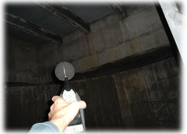
Figure 2 : emplacement du sonomètre sous la grille
