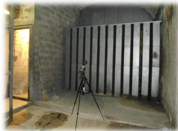
Figure 4 : emplacement du sonomètre derrière les baffles
