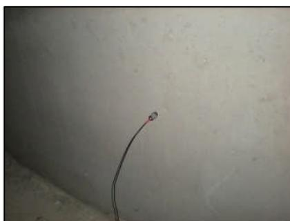
**PV2 : mesure vibratoire sur mur
