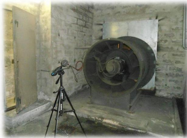
Figure 3 : emplacement du sonomètre face au ventilateur
